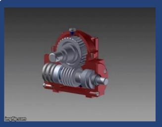
Die Welle hat ein Gewinde und schraubt so das Zahnrad in eine Drehbewegung
